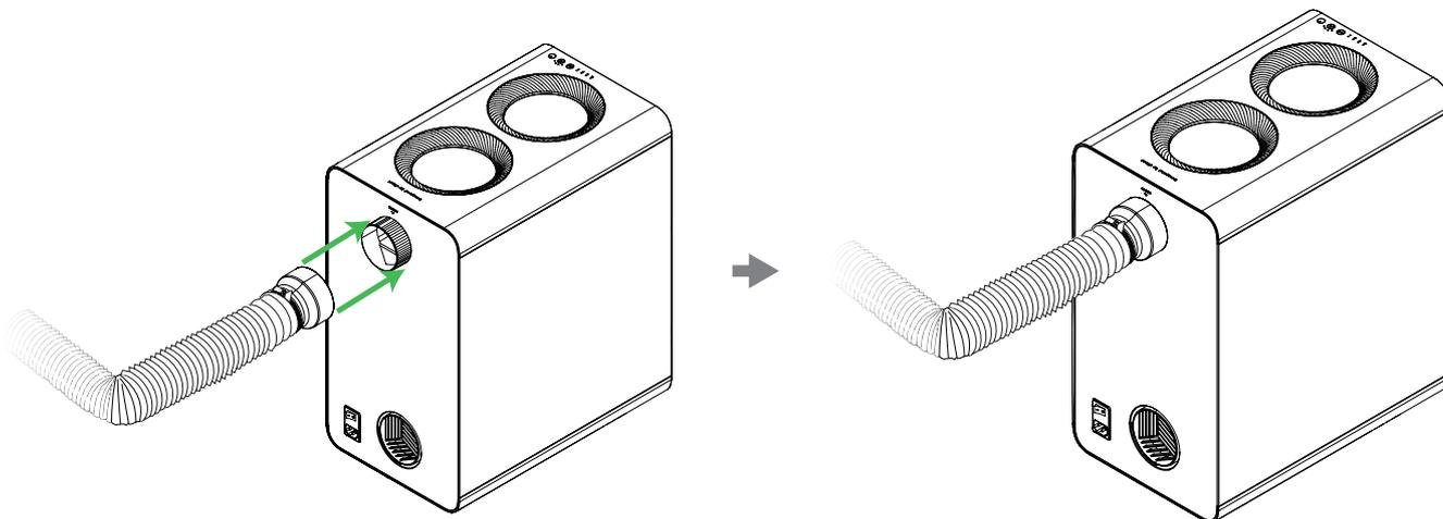
Connectez le connecteur de tuyau et le tuyau à l'entrée du débit d'air du purificateur.
