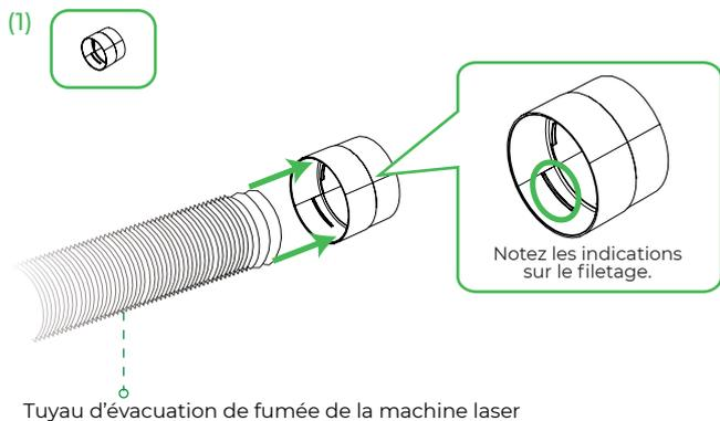
Connectez le tuyau d'évacuation de fumée de la machine laser au connecteur de tuyau 1.
