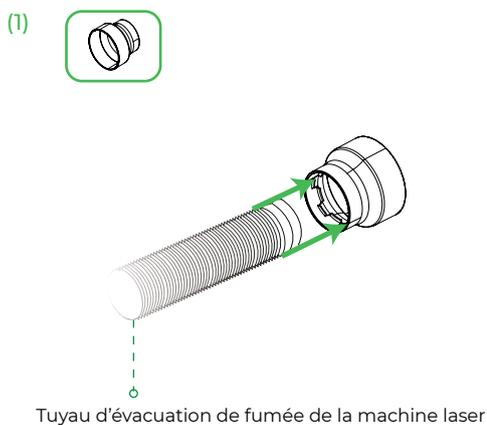
Connectez le tuyau d'évacuation de fumée de la machine laser au connecteur de tuyau 2.
