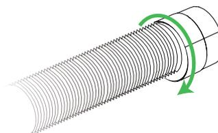
Faites tourner le connecteur de tuyau dans le sens inverse des aiguilles d'une montre pour fixer le tuyau et le connecteur.
