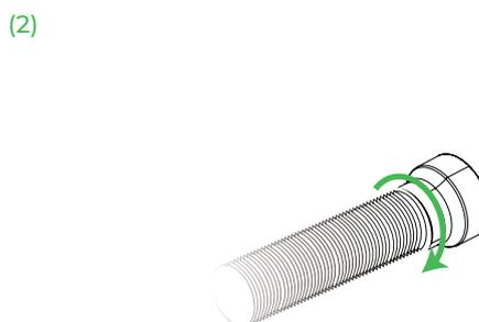
Faites tourner le connecteur de tuyau dans le sens inverse des aiguilles d'une montre pour fixer le tuyau et le connecteur.
