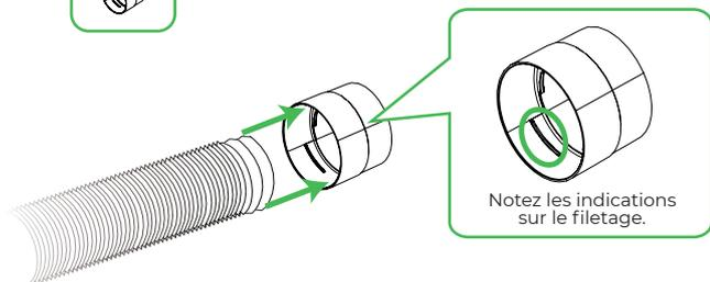
Connectez le tuyau d'évacuation de fumée inclus dans l'emballage au connecteur de tuyau 1.
